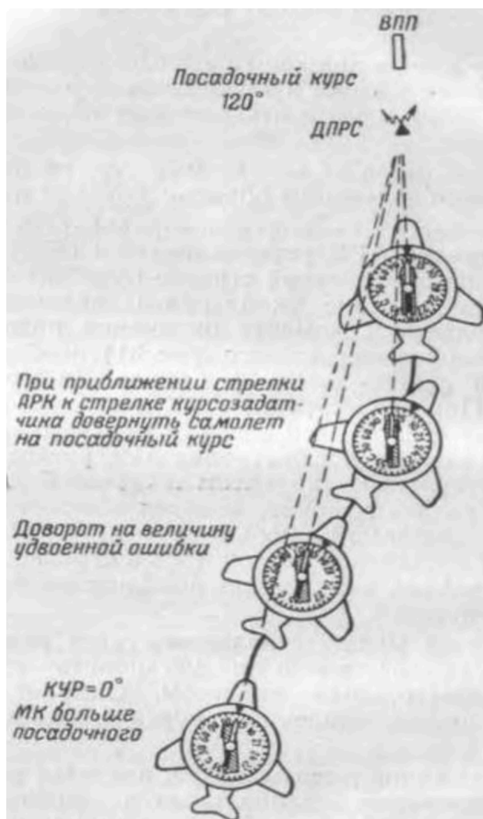
Рис. 32. Исправление ошибки при выходе на посадочный курс ( KУР=0^\circ , МК > МК_{\text{пос}} )
